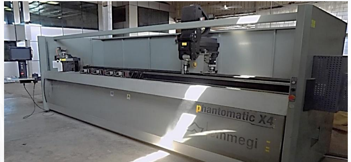
ماكينة معالجة وثقب قطاعات الألومنيوم الأتوماتيكية (الأبواب والنوافذ) CNC 4 Axes Machining Center (Doors & Windows)
