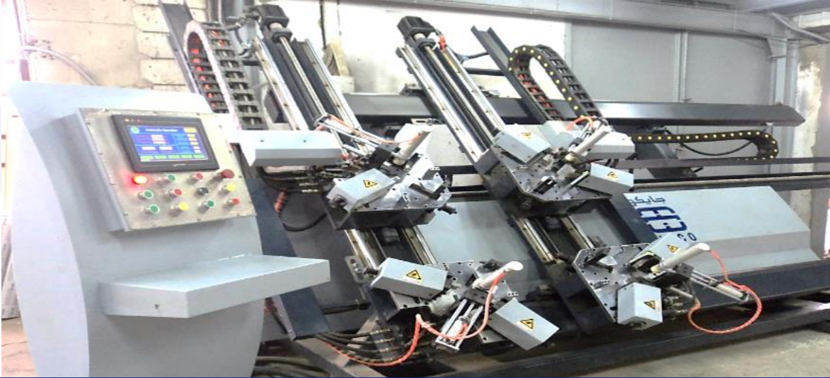
ماكينة تجميع الالمنيوم الأتوماتيكية الرباعية
